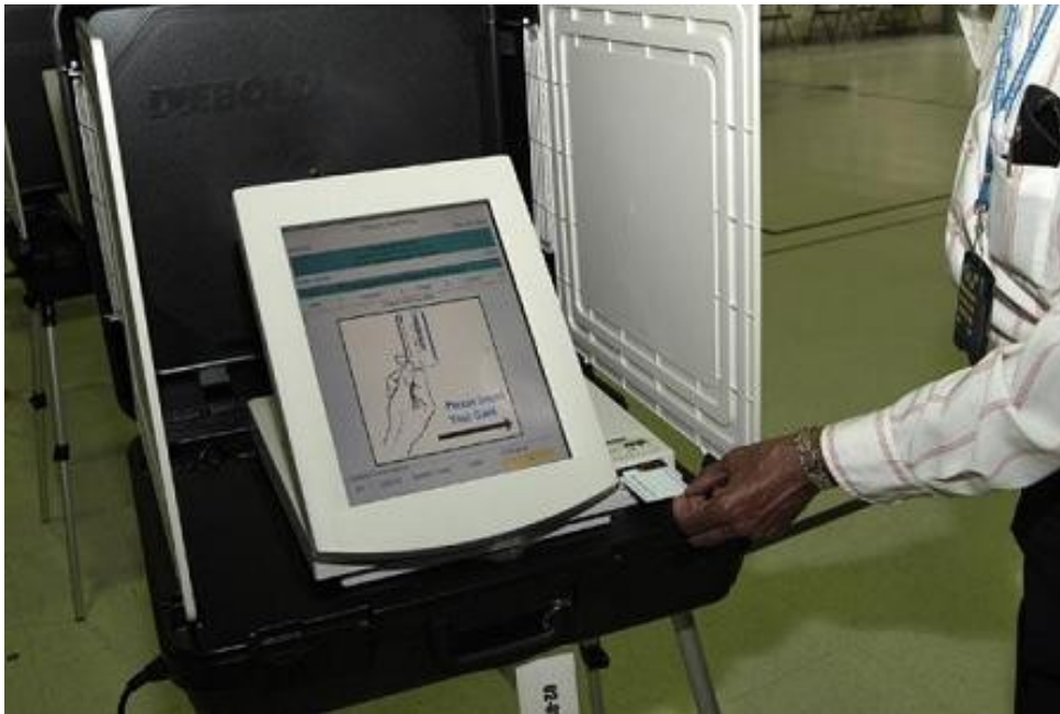
Abbildung 6: Touchscreen-E-Voting-Computer vom Hersteller Diebold. Quelle Wikipedia.org http://en.wikipedia.org/wiki/Voting_machine
