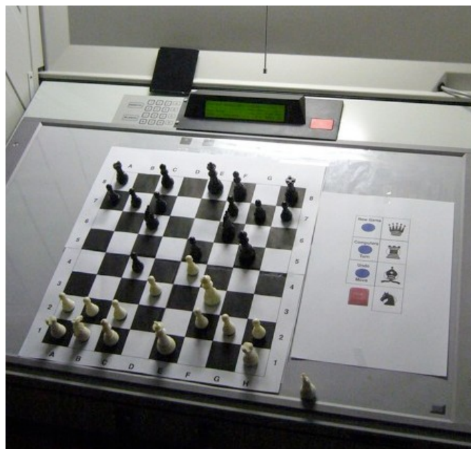
Abbildung 16: Umfunktionierte Nedap Wahlmaschine mit Schachprogramm. Quelle [GoHe06, S. 10]
